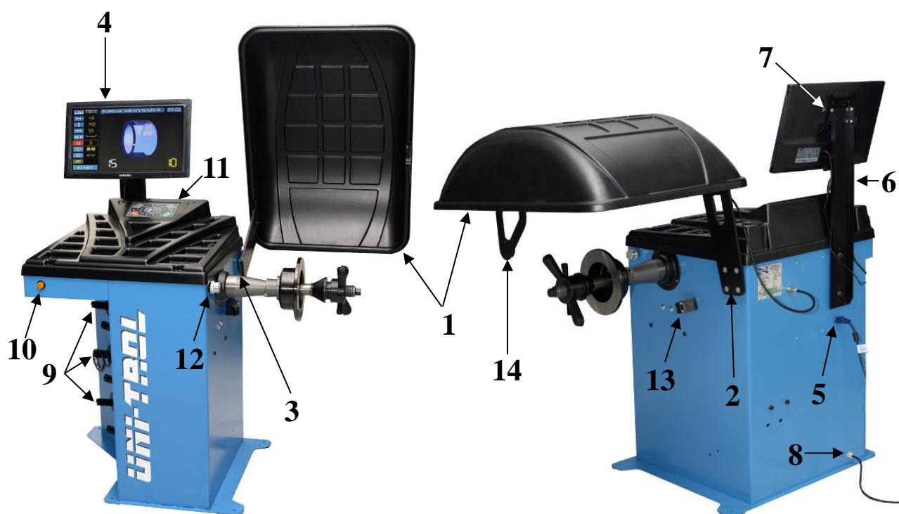
Rys. 2.1 Wyważarka i jej elementy
