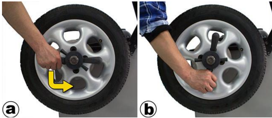
Rys. 5.8 Zdejmowanie koła z uchwytu wyważarki.
