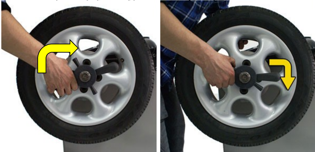
Rys.7 Mocowanie koła (pozycje LUZ i DOCISK)
