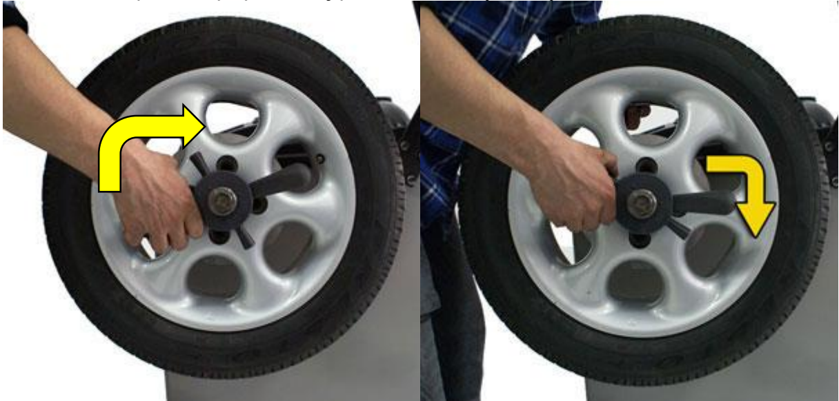
Rys.7 Mocowanie koła (pozycje LUZ i DOCISK)
