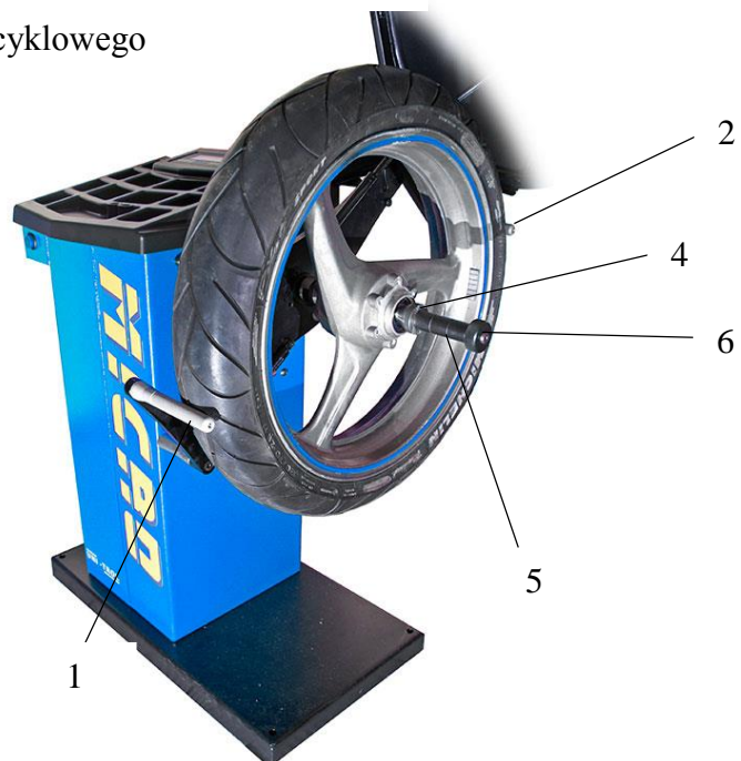
Rys.4 Montaż koła na uchwycie
