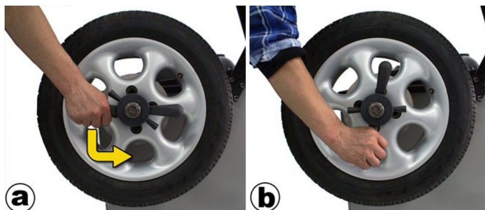
Rysunek 9: Zdejmowanie koła z uchwytu wyważarki.
