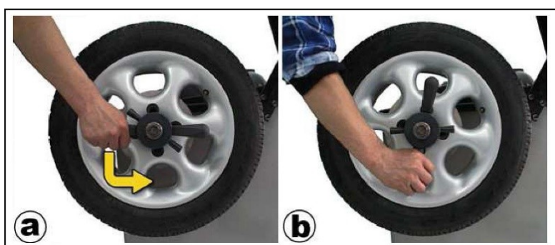
Rys. 5.7 Zdejmowanie koła z uchwytu wyważarki
