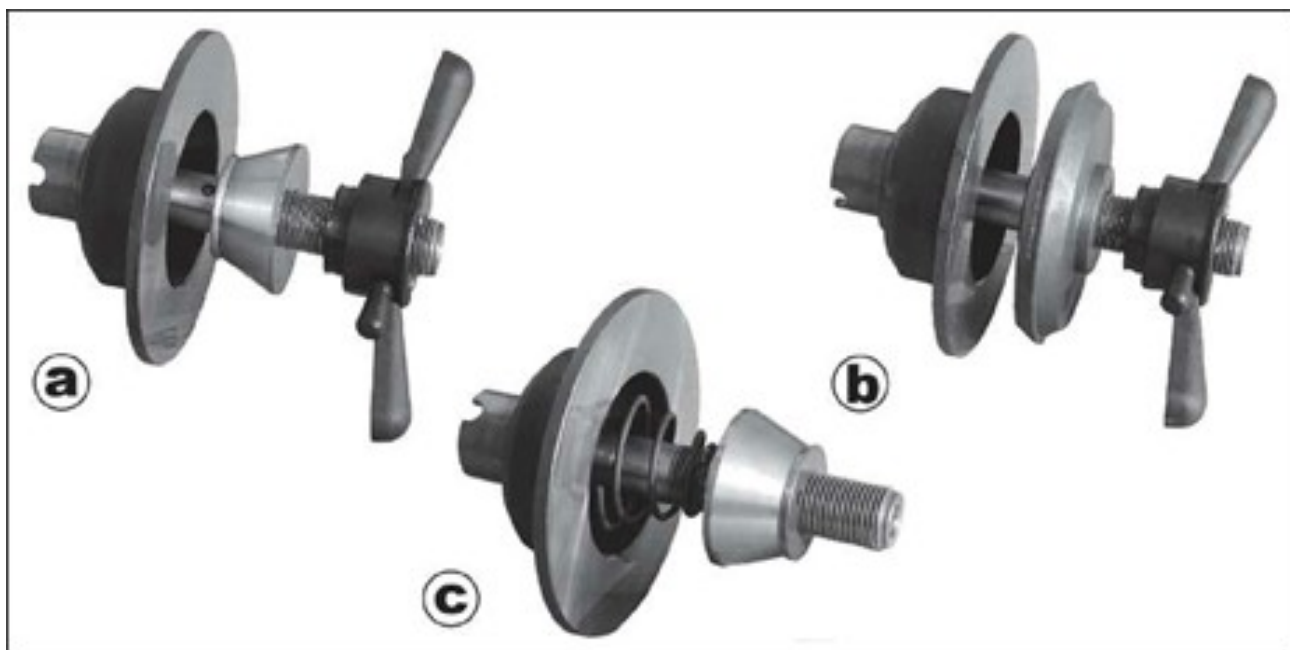
Rys. 5.8 Różne sposoby użycia uchwyty i jego wyposażenia
