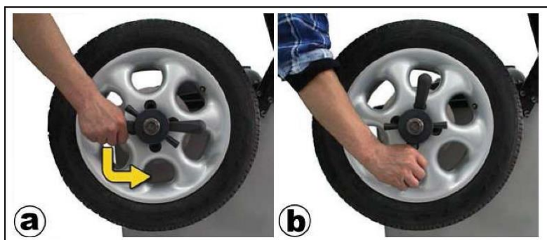
Рис. 5.7 Снятие колеса с адаптера балансировочного стенда..
