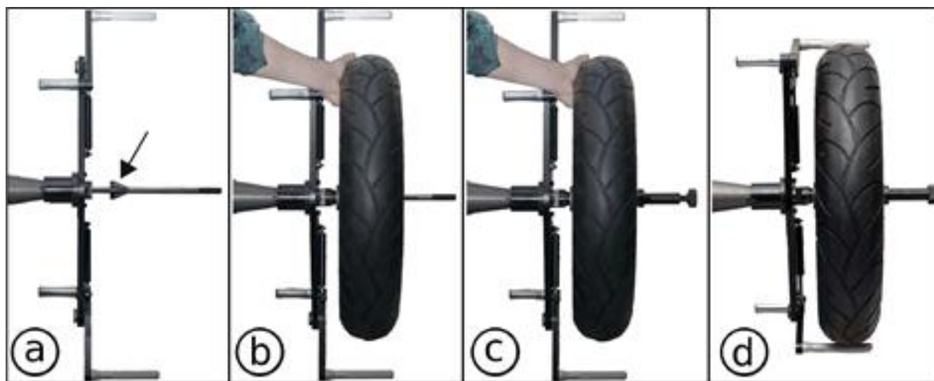
Рис. 5.13 Установка мотоциклетного колеса в адаптере.
