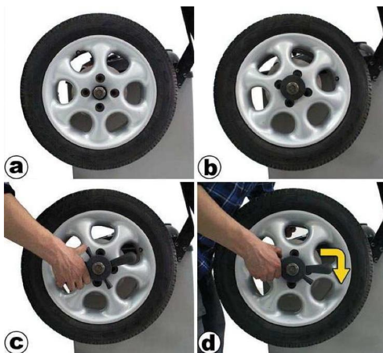
Рис. 5.6 Крепление колеса на адаптере балансировочного стенда
