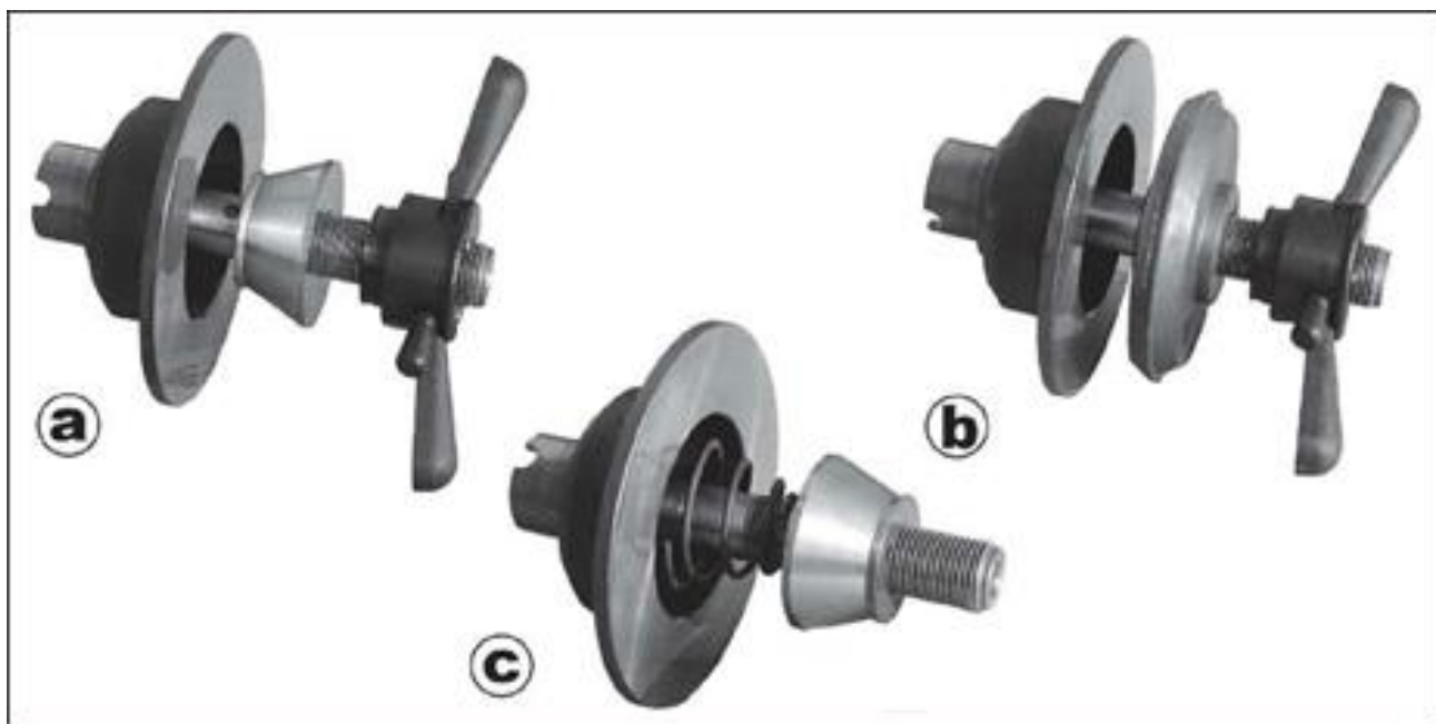
Рис. 5.8 Различные способы использования адаптера и его оснастки.
