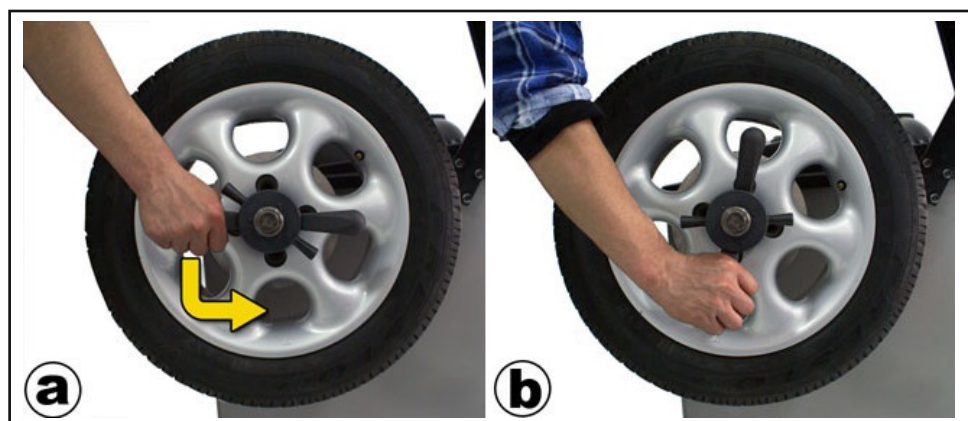
Rys. 5.8 Zdejmowanie koła z uchwyty wyważarki.
