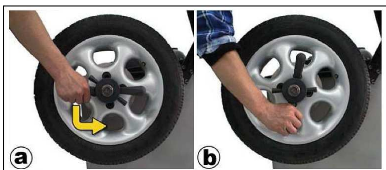
Rys. 5.9 Zdejmowanie koła z uchwytu wyważarki
