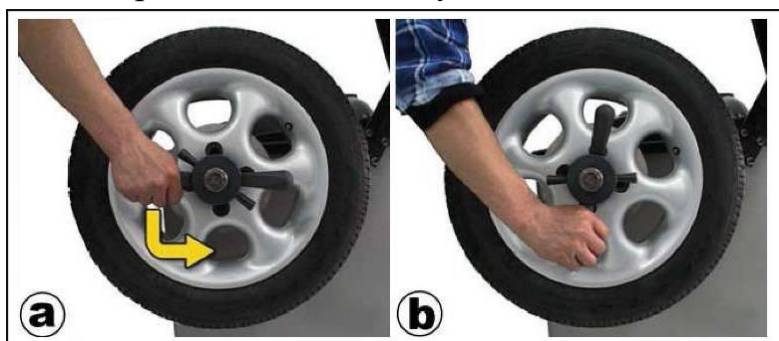
Рис. 5.9 Снятие колеса с адаптера балансировочного стенда..
