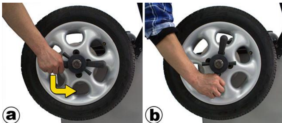
Rys. 5.8 Zdejmowanie koła z uchwytu wyważarki.
