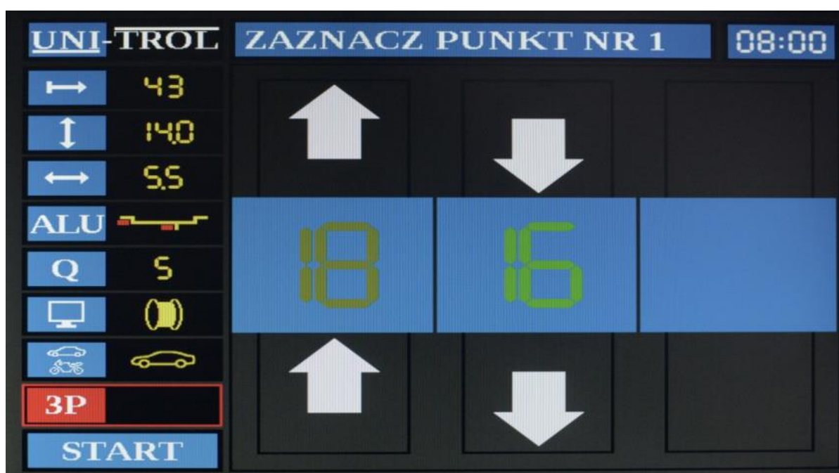
Rys. 6.5 – Ekran podprogramu „ukryty ciężarek” – zaznaczanie pierwszego miejsca
