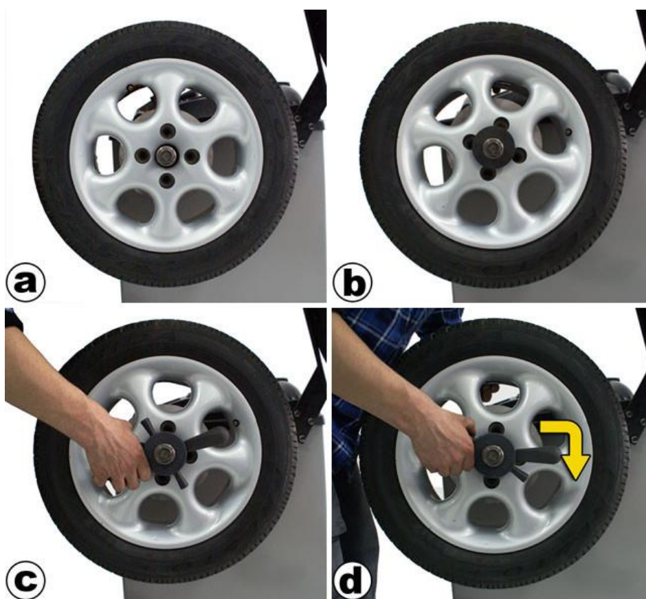
Rys. 5.7 Mocowanie koła w uchwycie wyważarki
