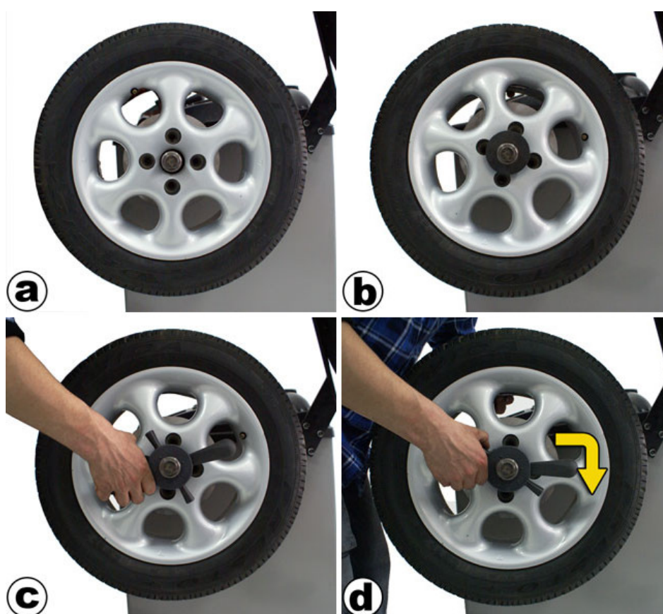
Rys. 5.7 Mocowanie koła w uchwycie wyważarki
