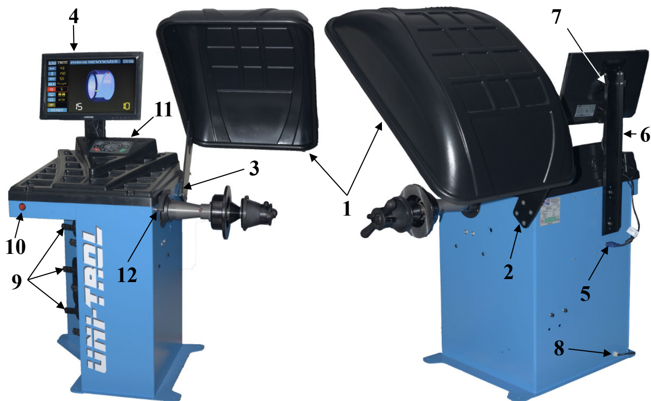
Rys. 2.1 Wyważarka i jej elementy
