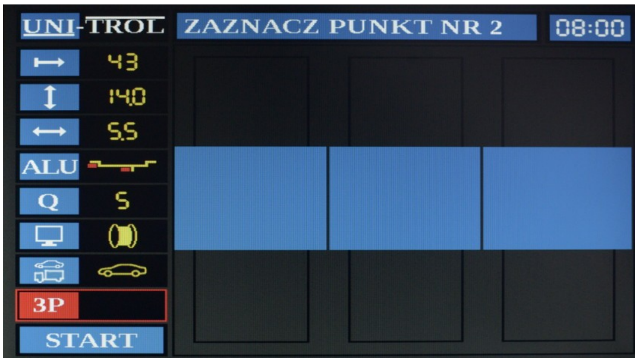
Rys. 6.6 – Ekran podprogramu „ukryty ciężarek” – zaznaczanie drugiego miejsca
