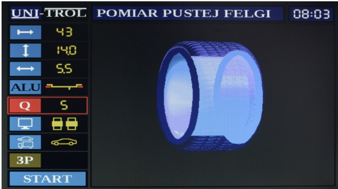
Rys. 6.10 – Ekran programu Optymalizacji – pomiar pustej felgi
