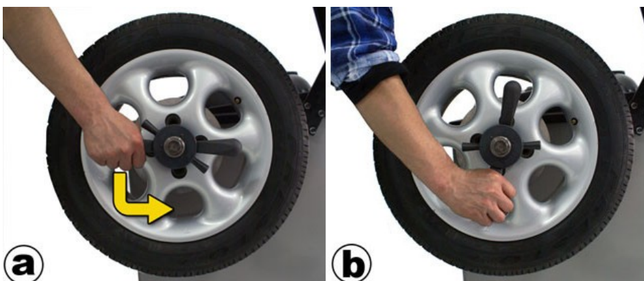
Rys. 5.8 Zdejmowanie koła z uchwytu wyważarki.
