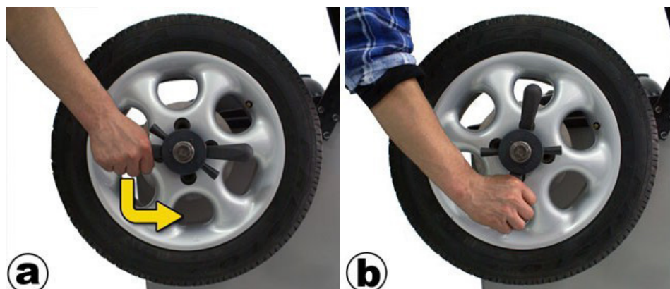
Rysunek 9: Zdejmowanie koła z uchwytu wyważarki.
