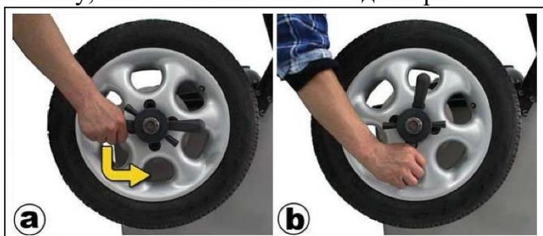
Рис. 5.7 Снятие колеса с адаптера балансировочного станда..
