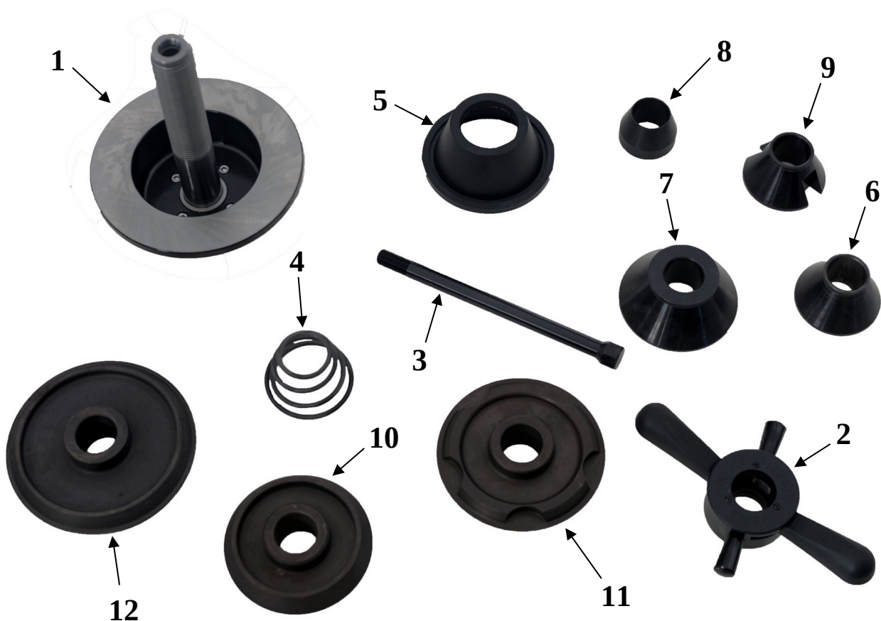
Rysunek 4: Elementy uchwytu: 1: nasada z flanszą 2: nakrętka dociskowa 3: śruba do mocowania nasady na wrzecionie 4: sprężyna 5: docisk nakrętki 6: stożek centrujący nr 1 7: stożek centrujący nr 2 8: stożek centrujący nr 3* 9: stożek centrujący nr 4* 10: stożek centrujący nr 5 (110mm-125mm)* 11: stożek centrujący nr 6 (125mm-145mm)*, 12: stożek centrujący nr 7 (145mm-165mm)*
