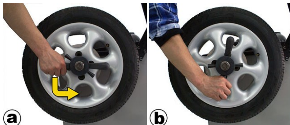
Rysunek 9: Zdejmowanie koła z uchwytu wyważarki.
