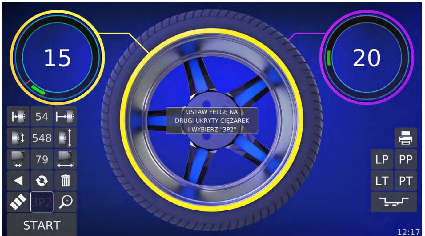
Rysunek 22: funkcja ukrytego ciężarka – wybieranie drugiego punktu
