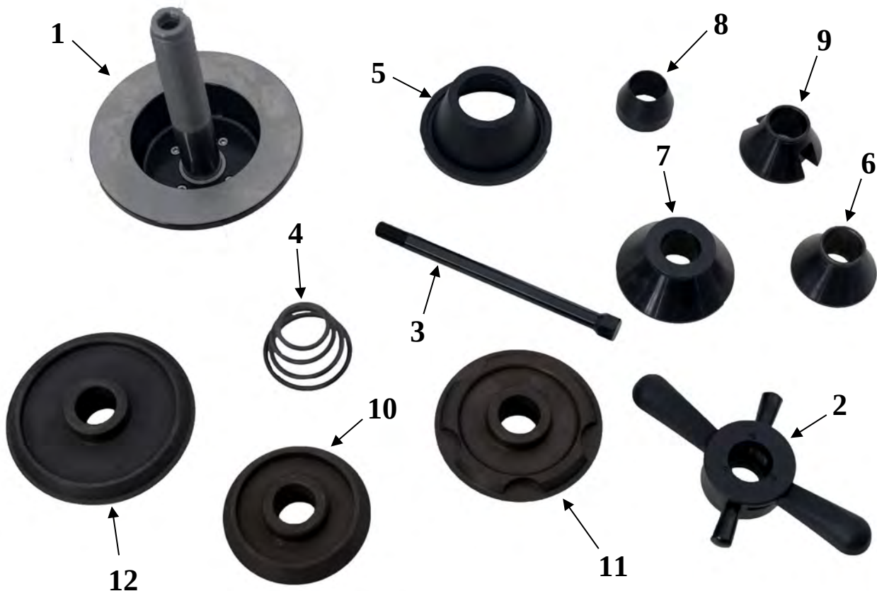
Rysunek 4: Elementy uchwytu: 1: nasada z flanszą 2: nakrętka dociskowa 3: śruba do mocowania nasady na wrzecionie 4: sprężyna 5: docisk nakrętki 6: stożek centrujący nr 1 7: stożek centrujący nr 2 8: stożek centrujący nr 3* 9: stożek centrujący nr 4* 10: stożek centrujący nr 5 (110mm-125mm)* 11: stożek centrujący nr 6 (125mm-145mm)*, 12: stożek centrujący nr 7 (145mm-165mm)*
