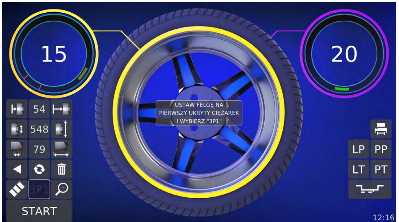
Rysunek 21: Rozpoczęta funkcja ukrytego ciężarka – wybieranie pierwszego punktu
