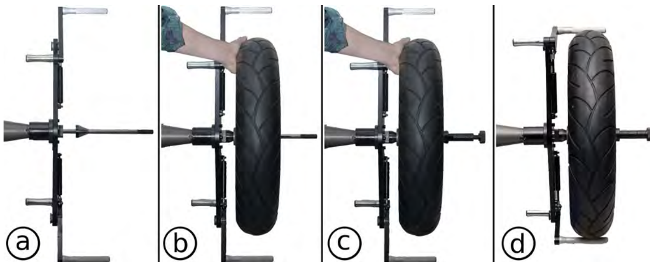
Rysunek 14: Mocowanie koła motocyklowego w uchwycie.
