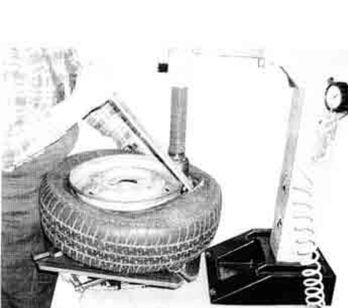
Fig. 10 Pulling tyre edge onto shoe
