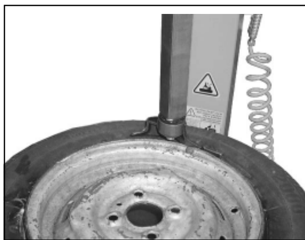
Rys. 8 Stopka w położeniu roboczym
