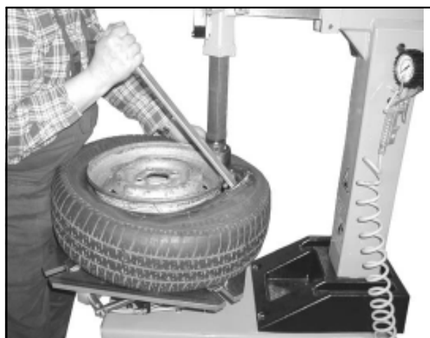
Rys. 9 Zakładanie brzegu opony na gruszkę
