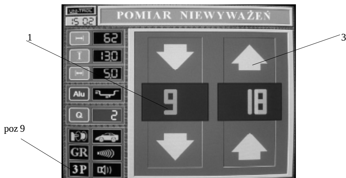
Rys. 17 Cyfry 9 i 18 to przykładowe wartości niewyważań
